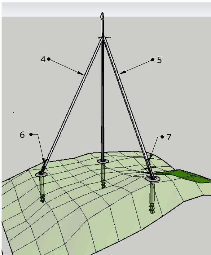
2. POSIZIONARE E FISSARE LE DUE SAETTE DI RINFORZO (RIF. 4 E 5) UTILIZZANDO LE STAFFE PER SAETTA (RIF. 6 E 7) E LA VITERIA IN DOTAZIONE VEDI DETTAGLI A PAGINA 2.
