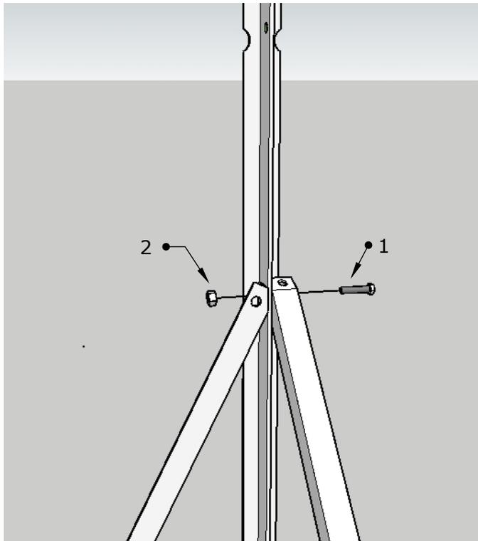
FISSARE LE DUE SAETTE NELLA PARTE SUPERIORE DEL PALO COME RIPIORTATO IN FIGURA 3 CON:
