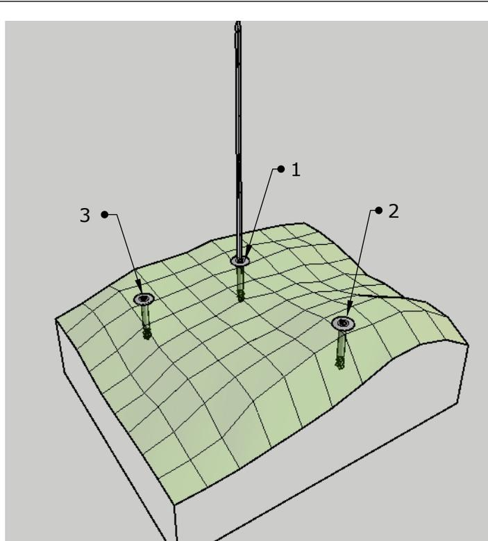
1. AVVITARE, CON L'APPOSITA CHIAVE MANUALE, IL SUPPORTO (RIF. 1) SULL'ANGOLO DELLA RECINZIONE ED AVVITARE I DUE SUPPORTI (RIF. 2 E 3) ALLA GIUSTA DISTANZA AL FINE DI FISSARE LE SAETTE DI RINFORZO.
